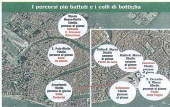
Elaborazione Coses della capacità pedonale dei percorsi urbani: oltre la soglia massima indicata per i diversi punti nevralgici (in rosso) è necessario provvedere a una diversa e forzata ridistribuzione dei fruitori di Venezia
